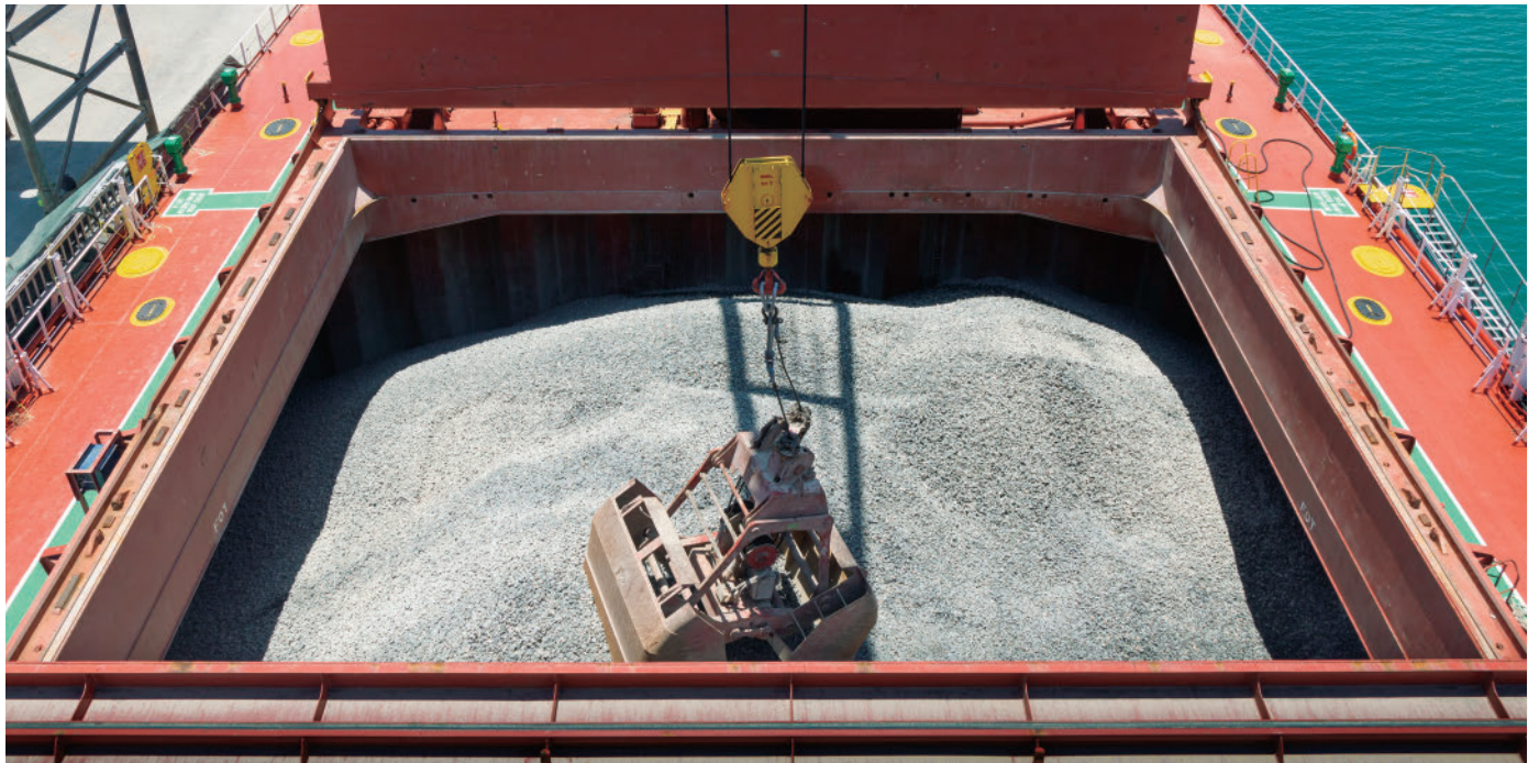
El proyecto incluye el transporte de más de 450.000 toneladas de balasto por vía marítima.
